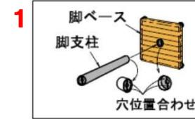
脚ベース木部側の中央の穴に脚支柱をはめ込みます。脚ベースと脚支柱の穴位置を合わせてください。(脚支柱のパイプに上下の区別はありません)
