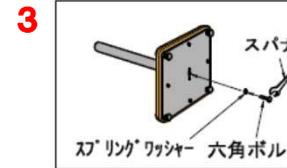
六角ボルトにスプリングワッシャー(大)をはめ、同梱のスパナを使用して脚支柱と脚ベースをかたく組付けします。
