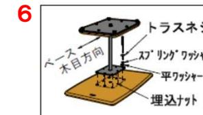
天板の埋込ナットと受座のネジ穴の位置を合わせて置き、トラスネジにスプリングワッシャー(小)と平ワッシャーをはめ、ドライバーで8ヶ所、それぞれかたく組付けして完成です。
