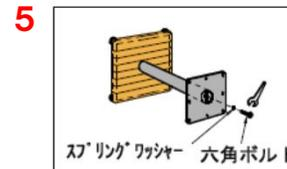
3と同様に六角ボルトにスプリングワッシャー(大)をはめ、スパナを使用して脚支柱と受座をかたく組付けします。
