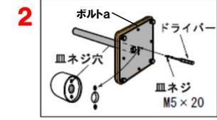
脚支柱と脚ベースの回り止め用の皿ネジをドライバーでかたく組付けします。皿ネジをきちんと締め付けることができない場合は、ホルタa(4本)をゆるめて、金属板の穴位置を調節してください。
