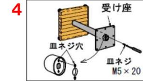
脚支柱と受座を組付けます。受座の皿穴を外側にして2と同様に組付けします。
