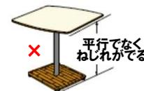
右図のように床にテーブルを置き、受座・脚ベースのネジ(計12個)をすべてゆるめて平行を調整してください。
