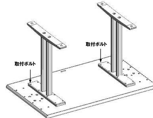
天板の埋込ナットと脚組付穴の位置を合わせて脚を置き、付属の取付ボルト16本を組付穴にはめ、ドライバーでかたく組付けて完成です。
